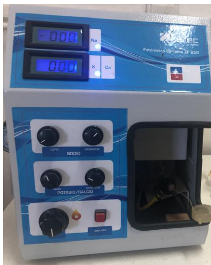
Figura 12: Fotómetro de llama, para valoración potasio (fuente propia)
