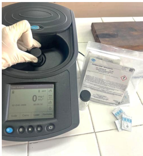
Figura 16: Medición de sulfatos en agua con un espectrofotómetro (fuente propia).
