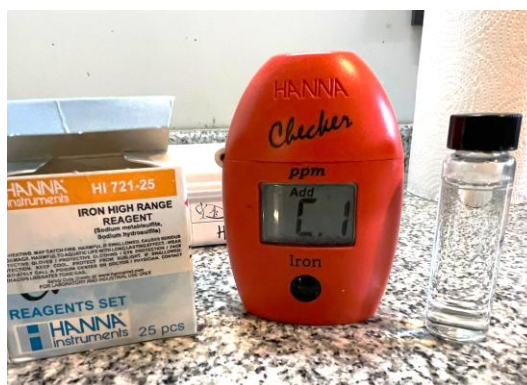
Figura 19: Colorímetro para la determinación de hierro en agua (fuente propia)
