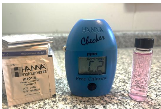
Figura 18: Colorímetro de bolsillo para la determinación de cloro libre en agua (fuente propia)
