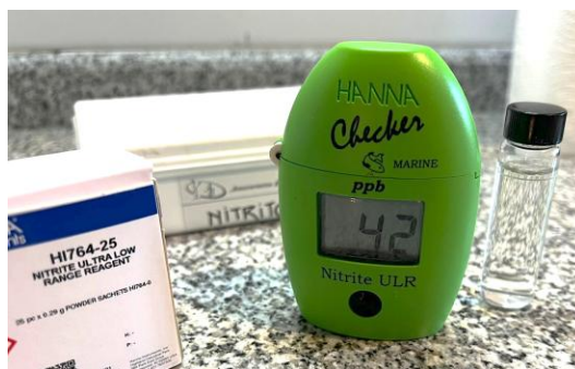
Figura 17: Colorímetro de bolsillo para la determinación de nitritos en agua (fuente propia)
