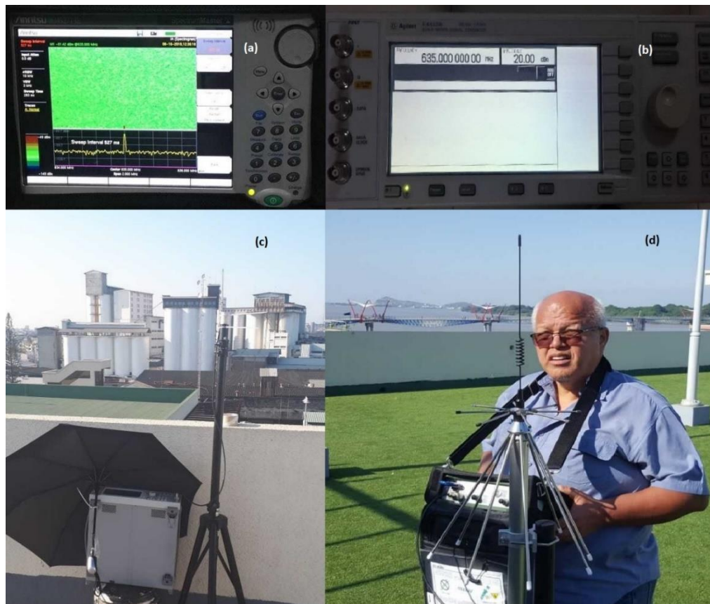
Fig. 4.4 Sistema de Medición en el edificio pequeño. (a) Analizador de espectros Anritsu. (b) Generador RF, Agilent. (c) Sistema Transmisor. (d) Sistema Receptor
