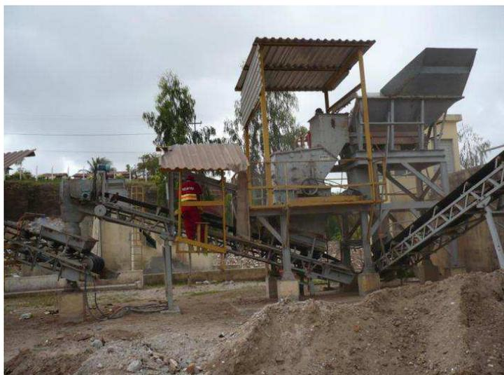
**Figura 7.22** Planta de nivel 2 con separación manual en la línea de producción.
