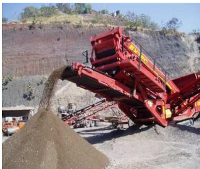
**Figura 7.20** Equipo de cribado móvil.
