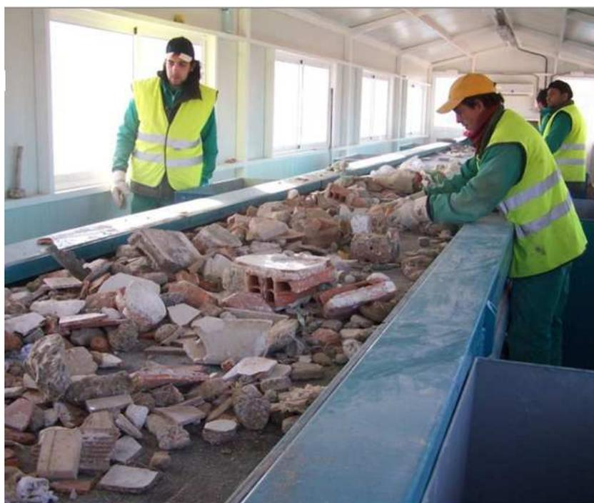
**Figura 7.7** Vista interna de una cabina de separación manual
