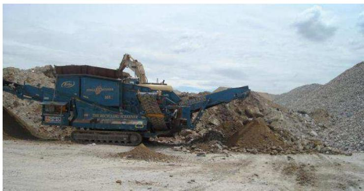
**Figura 7.21** Planta de reproceso móvil, nivel 1
