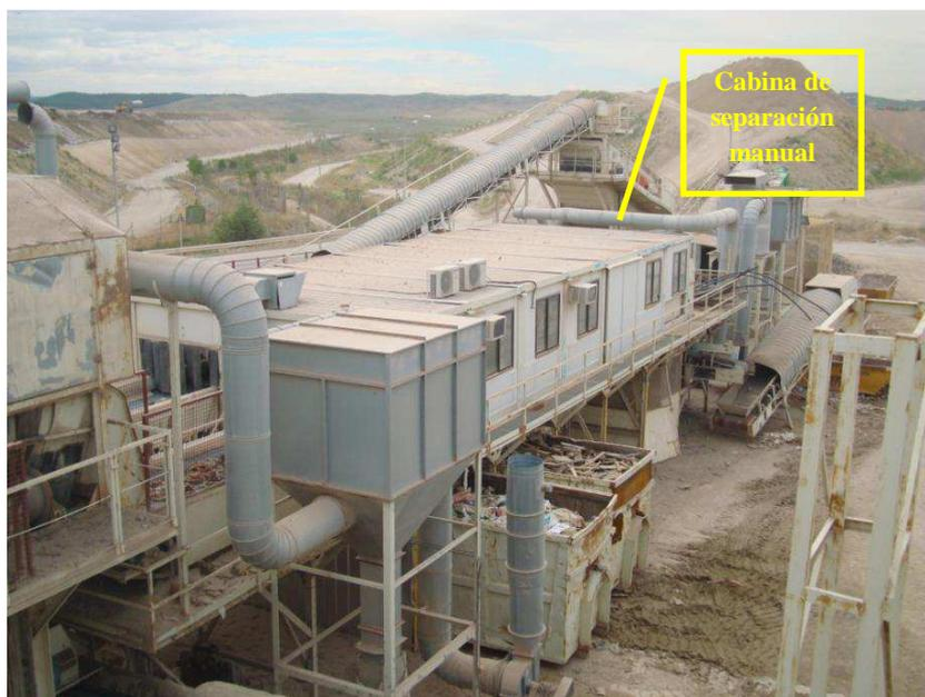
**Figura 7.6** Vista externa de una cabina de separación manual
