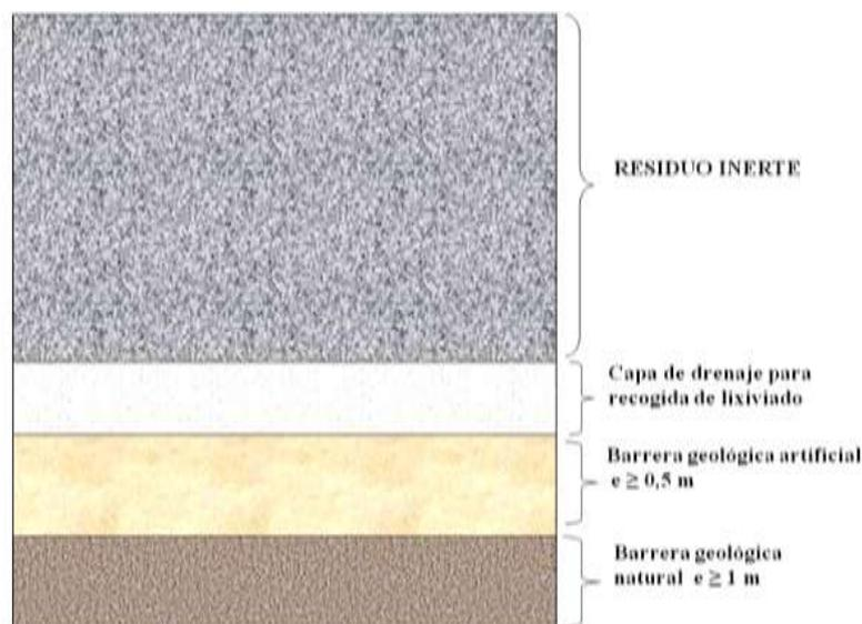
**Figura 1.8.** Esquema de las barreras impermeabilizantes en vertederos de inertes.
