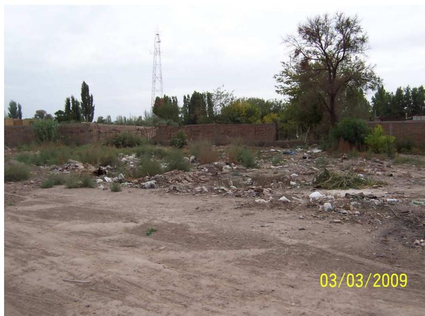
**Figura 5.4.** Vertido incontrolado de RCD de tipo superficial
