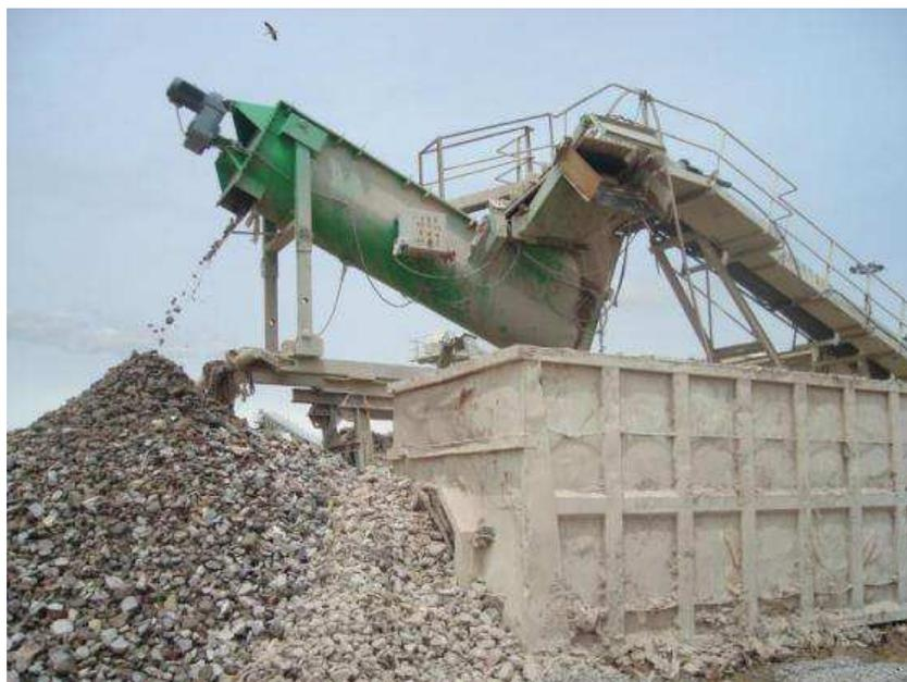
**Figura 7.8** Separador hidráulico
