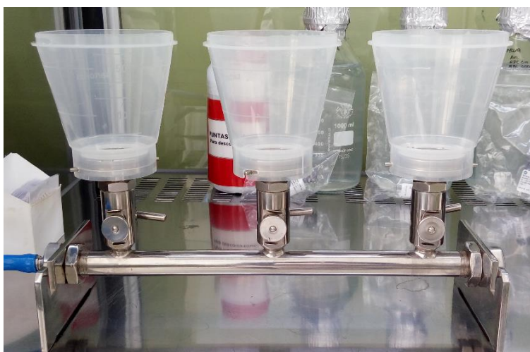
Figura 5: Equipo de filtración.
