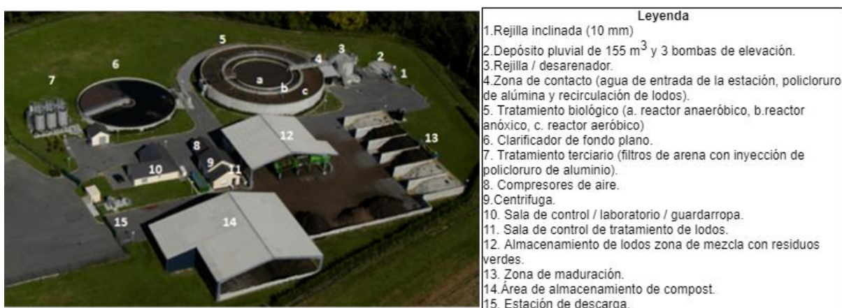
Figura 5: Elementos de la depuradora y de la estación de compostaje Uzein.
