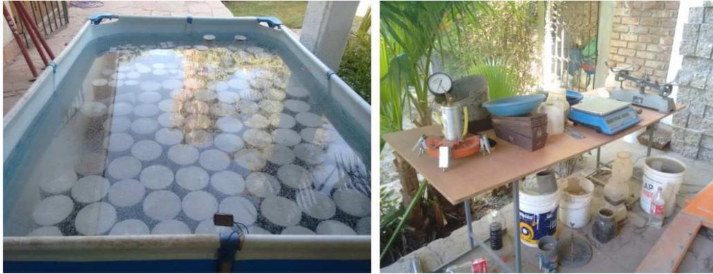
*Figura 3 – A la izquierda: Pileta utilizada para el curado y almacenamiento de las distintas probetas. A la derecha: se observa equipamiento para los distintos ensayos realizados.*
