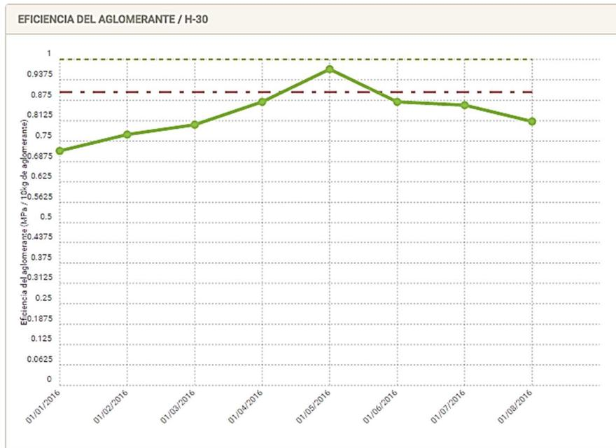
*Figura 16 – Eficiencia del cemento respecto de los meses analizados.*
