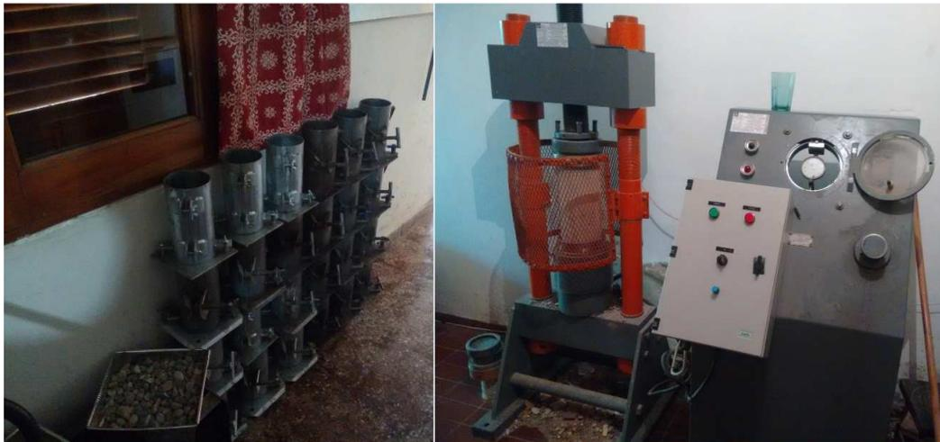
*Figura 2 – A la izquierda: Muestra de agregados y moldes para probetas. A la derecha: Prensa utilizada para ensayos de hormigón.*
